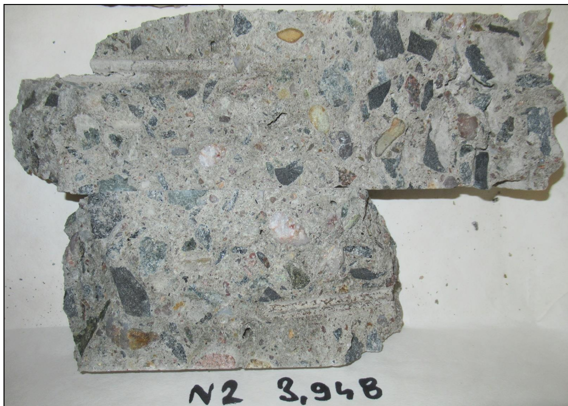
Foto 4: Části vzorku N2 před zkouškou na přítomnost ASR
