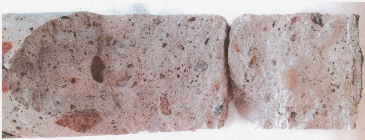
Obrázek č. 1: Fotodokumentace vývrtu 11/5-M1 – pohled na zkoušenou lomovou plochu
