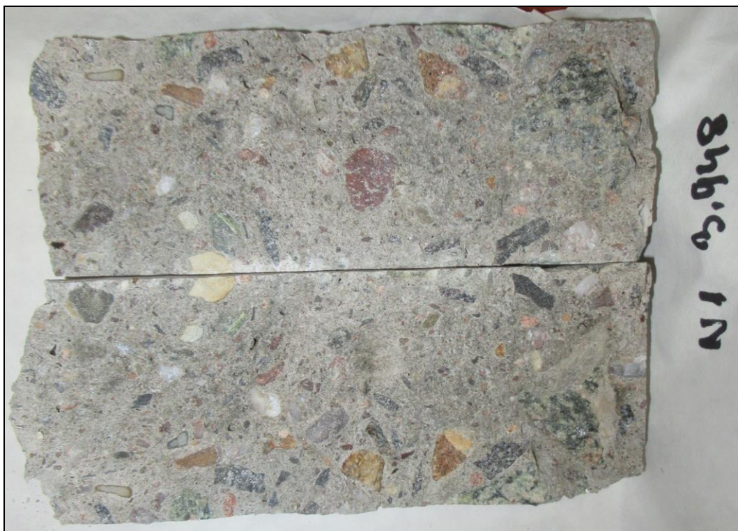
Foto 2: Části vzorku N1 před zkouškou na přítomnost ASR
